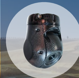
Гиростабилизированная платформа с тепловизором
